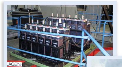
POWER PLANT RACKS SHAKING TEST
